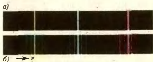
Рис. 2. а) Спектр ртутной лампы; б) спектр рассеянного света.
